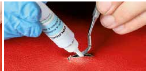
Die Vlies-Mitte ist mit einer Kreuzmarkierung versehen. So lässt sich kontrollieren, dass die Armierung an der richtigen Stelle sitzt. Anschließend wird Lederkleber eingespritzt
