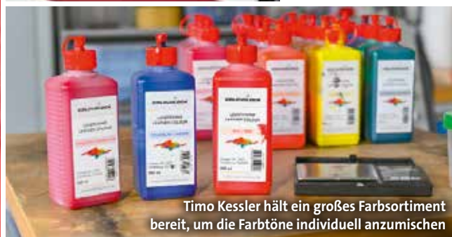
Anhand der per Scanner und App ermittelten Rezeptur mischt der Profi die Farbe auf der Feinwaage. Meist muss noch nachjustiert werden
