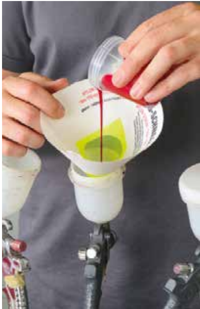
Der Farbton zum Egalisieren der Optik orientiert sich an den Kunstlederteilen, die anders als das Leder nicht ausgebleicht sind
