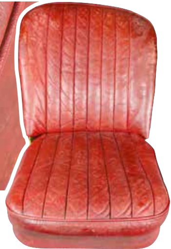
Zwischenstand, nachdem alle Leder-Reparaturen ausgeführt wurden
