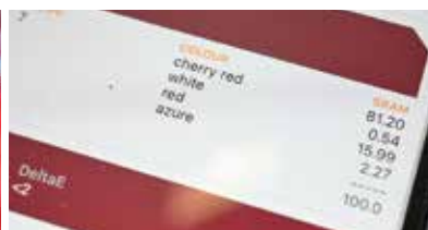
Der Farbscanner sendet sein Messergebnis an eine Smartphone-Applikation, die die Rezeptur zum Anmischen der Lederfarbe anzeigt
