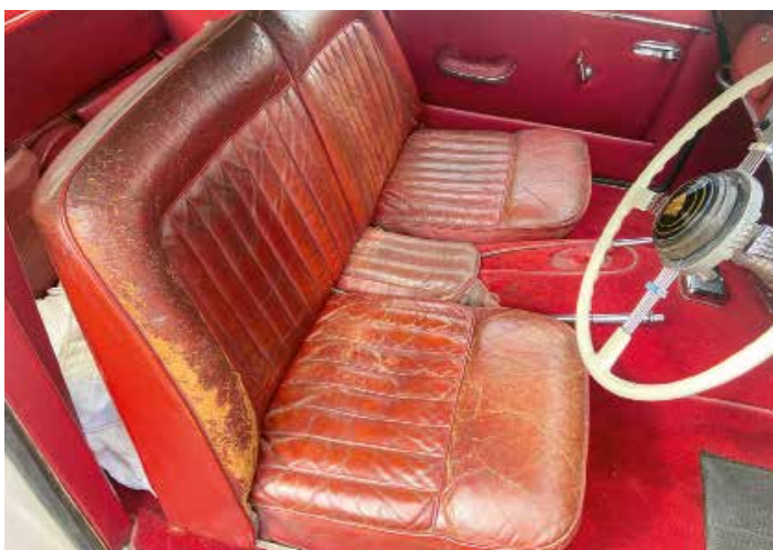
Ein weiteres eindrucksvolles Arbeitsbeispiel aus der „Glanzpunkt“-Werkstatt ist dieses Jaguar-XK-Interieur. Auftrag war, das sehr stark beschädigte Leder gegen weiteren Verfall zu stabilisieren, die in etlichen Jahrzehnten erworbene Patina aber zu erhalten. Sicher ein Extremfall, der die Grenze des Machbaren markiert
