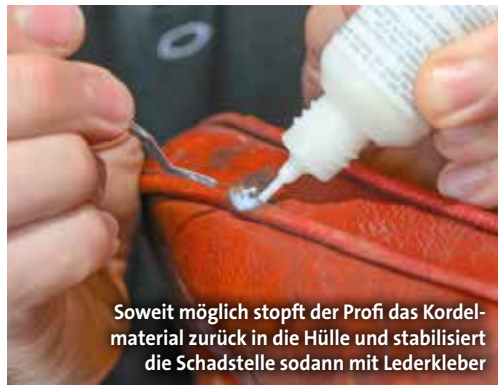
Der aufgerissene Keder ist eine Herausforderung für die Feinmotorik. Die herausstehende Seele wird per Skalpell gestutzt
