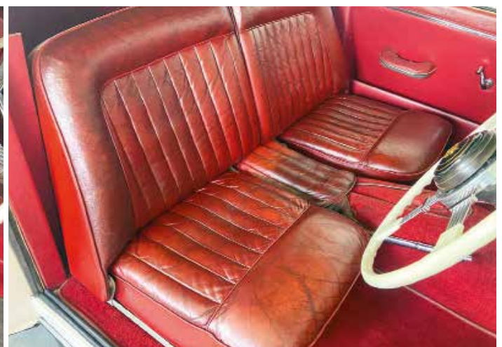
Ein weiteres eindrucksvolles Arbeitsbeispiel aus der „Glanzpunkt“-Werkstatt ist dieses Jaguar-XK-Interieur. Auftrag war, das sehr stark beschädigte Leder gegen weiteren Verfall zu stabilisieren, die in etlichen Jahrzehnten erworbene Patina aber zu erhalten. Sicher ein Extremfall, der die Grenze des Machbaren markiert
