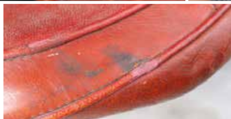
Das Ergebnis der Keder-Reparatur an zwei Stellen (l.): Nach dem Überlackieren wird der Schaden nicht mehr auffallen. R.: Ein Winkelriss im Kunstleder-Rücken muss mit Vlies hinterklebt werden
